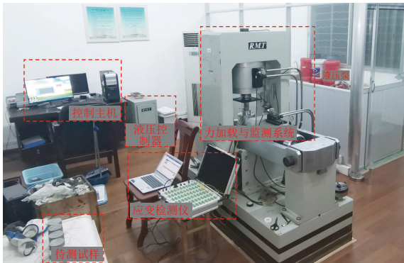
图 6 单轴压缩试验系统
