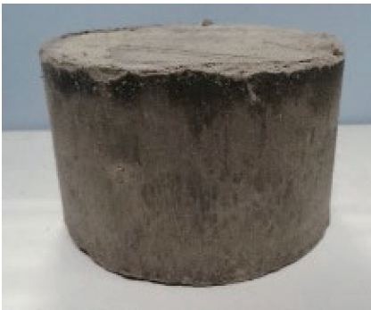
图 12 粉煤灰浆液压实体
