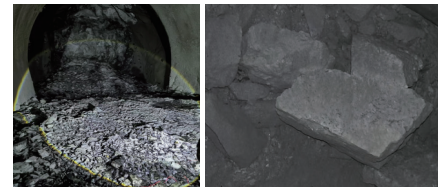
(b) 3号斜井IS0+975.6里程处取得的变质砂岩样品
