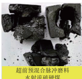
图 45 前混合磨料水射流与超前预混合脉冲磨料水射流破岩效果对比
