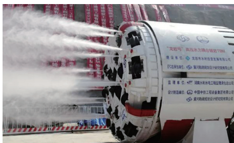
图 4 高压水射流耦合 TBM 龙岩号
