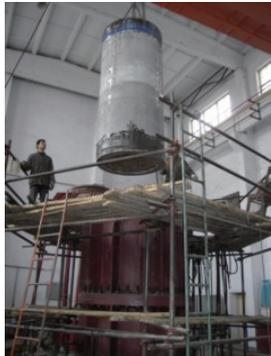
(a) 模型井壁吊入试验台
