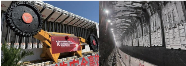
图 2 10 m 大采高综采开采部分开采装备及运行状态
