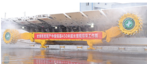
图 13 成套装备地面联调试验
