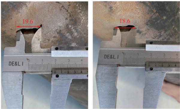
图 19 射孔后套管孔眼测量
