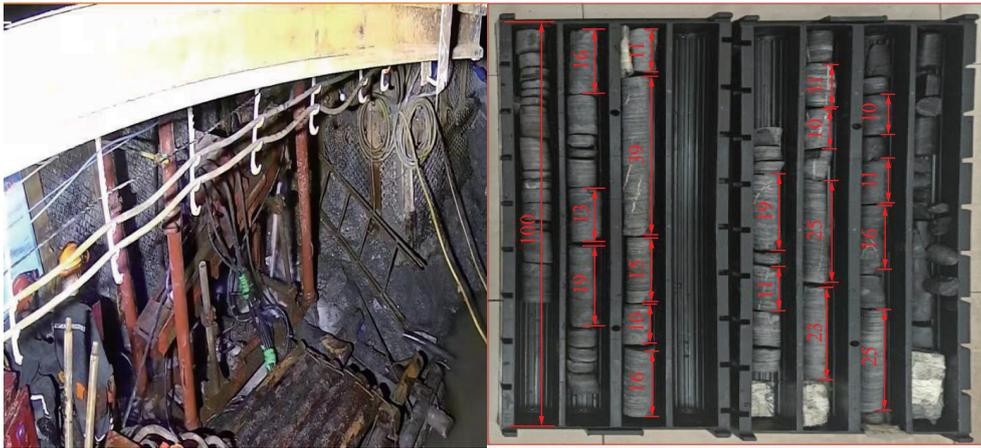
图 14 现场钻探及部分钻孔 RQD 统计
