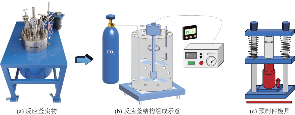
图 8 固碳矿用材料制备反应釜及预制件实验装置
