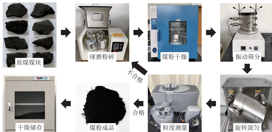
图2 煤粉制备流程
