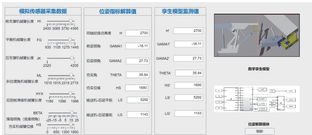
图 11 充填支护机器人位姿解算与孪生输出测试
