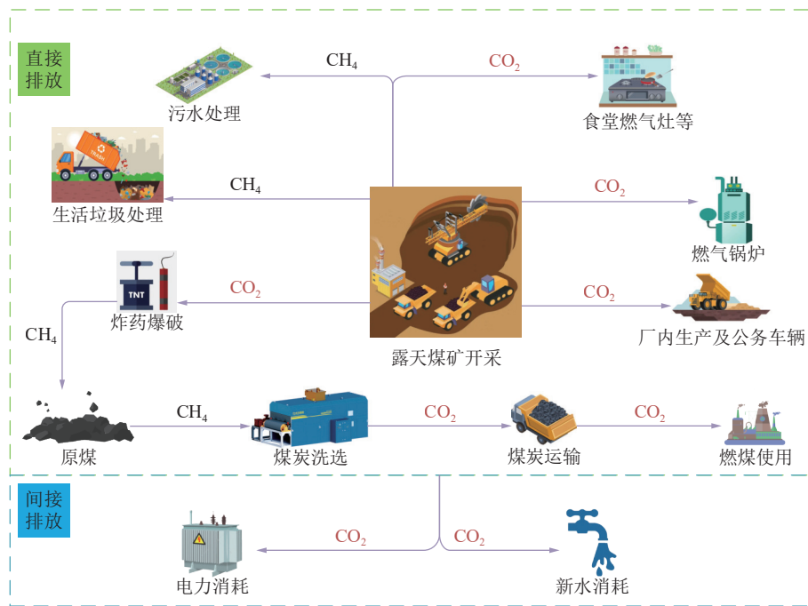
图 1 露天矿区煤炭生产企业核算边界和温室气体排放源示意
