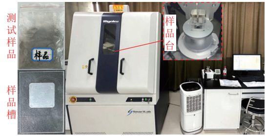
图4 泥质钻渣X射线衍射试验
