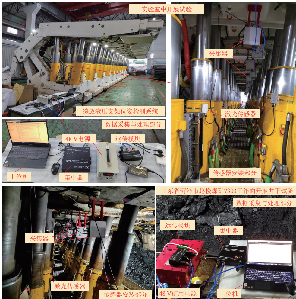
图 13 综放支架位姿检测试验系统
