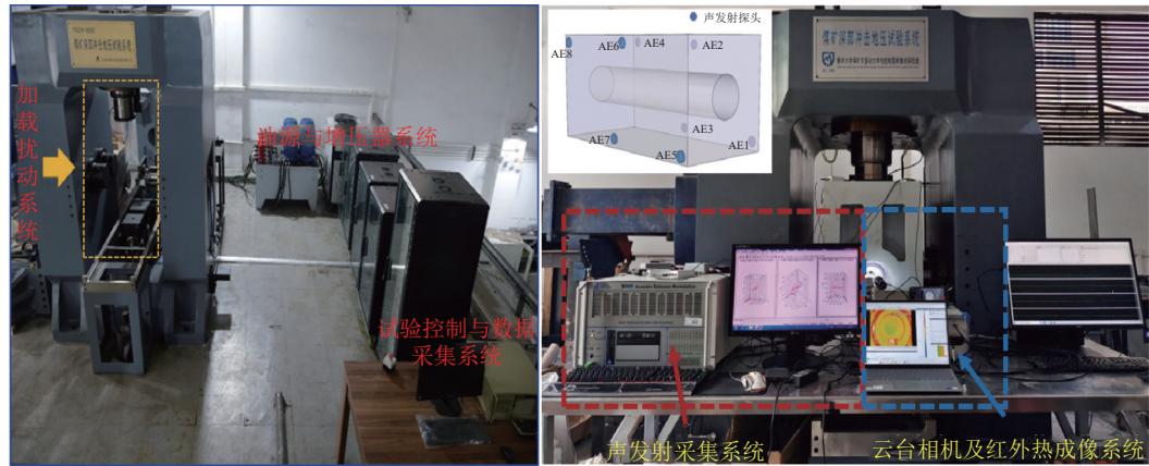
图 2 深部煤岩冲击地压多功能物理模拟试验系统
