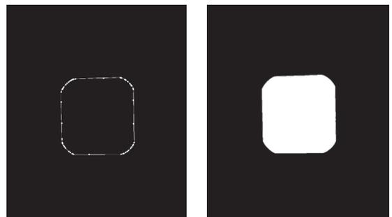
图 8 正方形光源轮廓外接图及面积图像
