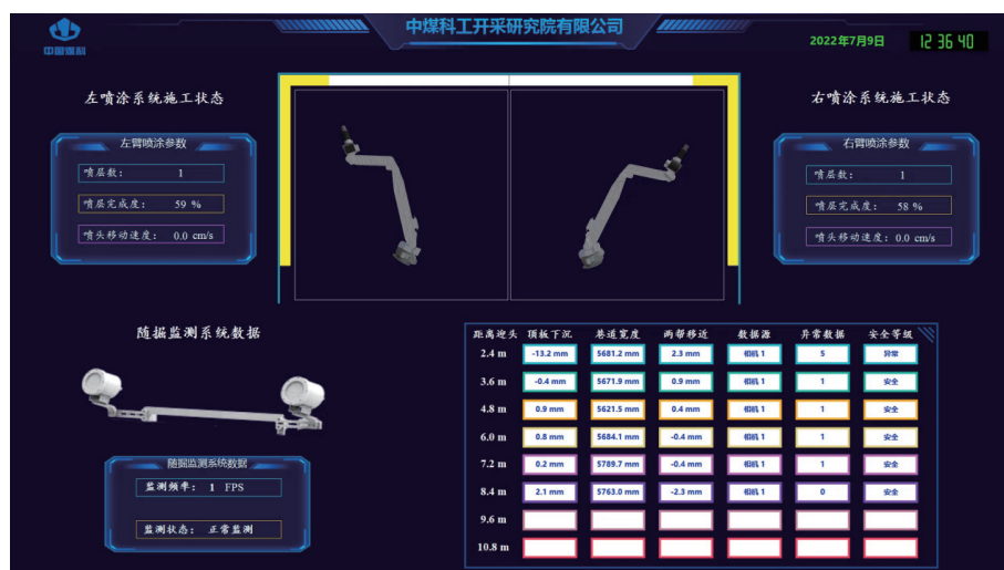
图 22 随掘变形动态监测远程集控界面
