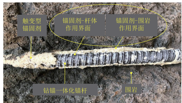
图6 钻锚一体化锚杆锚固剖面
