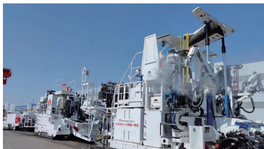
图 23 钻锚一体化快速掘进成套装备
