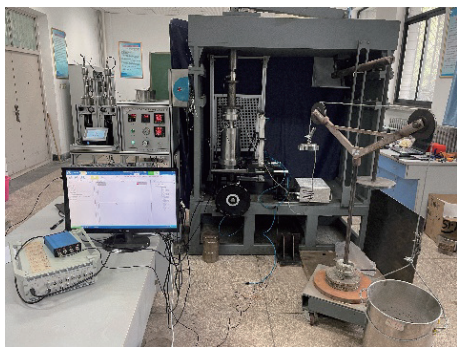
图2 RRTS-IV 型岩石流变扰动效应试验系统
