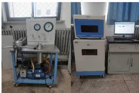
图3 ZYB-II 型真空加压饱和装置与核磁共振分析系统
