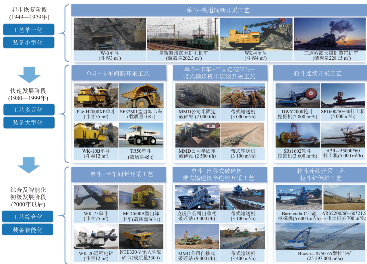
图7 露天煤矿不同发展阶段代表性开采工艺及开采装备
