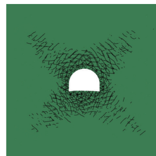
图 6 围岩裂隙分布
