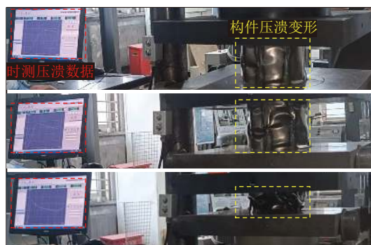
图 13 吸能构件压溃实验过程
