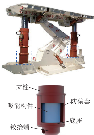
图 1 液压支架及防冲吸能装置基本结构
