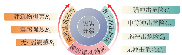
图7 基于地表建筑物损伤及井下工作面冲击地压的灾害分级模型
