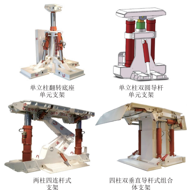
图21 超前支护防冲支架
