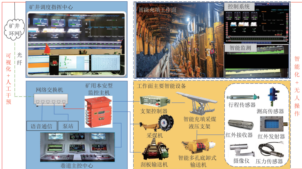
图 11 煤基固废固体智能充填采煤技术原理
