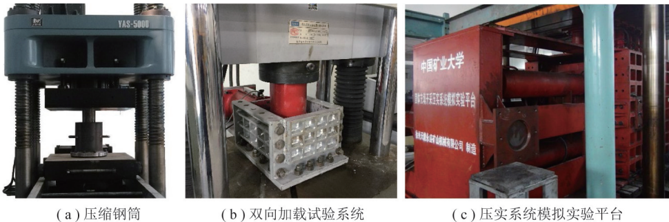
图 7 全尺寸充填材料压缩特性测试装置
