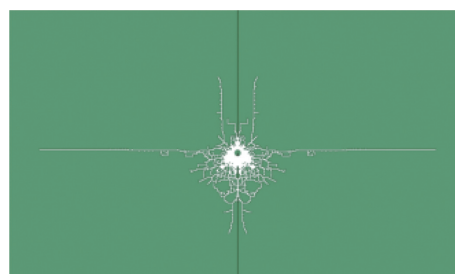
图3 炸药在钻孔下部裂隙扩展示意
