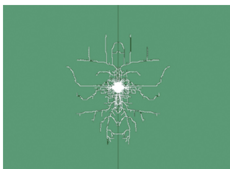
图 13 水耦合聚能爆破
